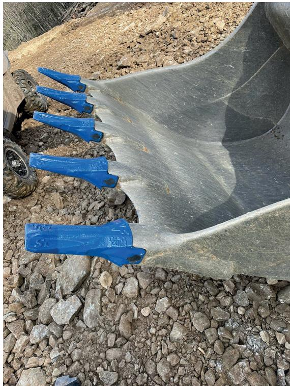
**TURNKEY® Grizzly** est une nouvelle gamme complète d'outils d'attaque au sol utilisant un clavetage sans marteau à compression permanente pour les dents.
