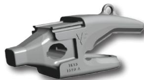
**Abrasion A10° :** Adaptateur pour excavatrice. Un chapeau d'usure vient se fixer sur la branche supérieure. L'angle du nez présente une inclinaison de 10°. Excellente résistance à l'abrasion.
