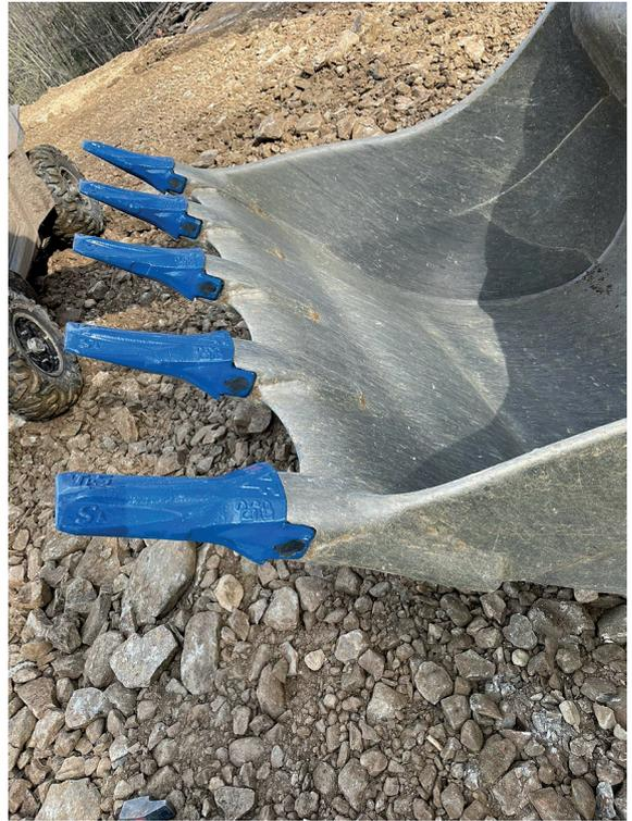
*TURNKEY® Grizzly* est une nouvelle gamme complète d'outils d'attaque au sol utilisant un clavetage sans marteau à compression permanente pour les dents.
