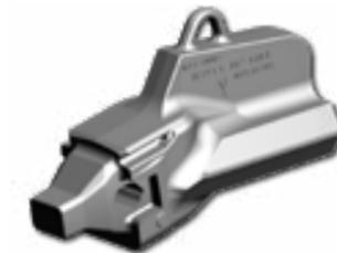
**Cast Corner :** Adapteur spécifique pour grosse excavatrice. Ce dernier comporte un début de lame et de flanc, et vient s'encasturer dans les cotés du godet. Il est le plus souvent utilisé en milieu très abrasif.
