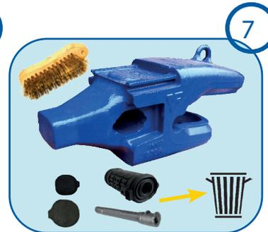
**Nettoyage :** Nettoyez l'adaptateur, les queues d'arrondés du chapeau d'usure ainsi que le passage clavette-fourreau et jetez le système de clavetage usagé. Le montage d'une nouvelle pointe doit se faire avec une clavette neuve et un fourreau neuf.
