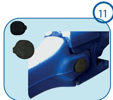
**Installation des bouchons de protections :** Insérez de chaque côté de la dent les bouchons de protection du clavetage qui limiteront l'entrée de matériaux dans le carré de clavetage (TK13CPL à gauche et TK13CPR à droite). Le but est de faciliter le démontage de la clavette lors de son remplacement ultérieur.
