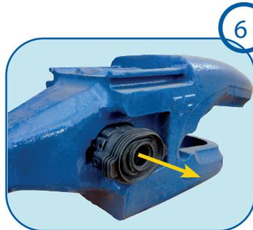
**Ejection du fourreau de clavetage (suite):** Une fois le fourreau délogé, pour pouvez finir l'extraction de ce dernier à la main.
