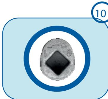
**Verrouillage correct (suite) :** Une fois le verrouillage accompli, votre axe de clavetage doit être dans cette position : Tête en haut.
