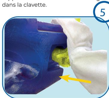
**Ejection du fourreau de clavetage :** Pour éjecter le fourreau, munissez-vous le l'outil de démontage et insérez la partie plate composée d'un appendice rond dans le fourreau par le côté gauche de l'adaptateur, et poussez avec la main afin de déloger le fourreau.
