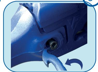
**Ejection de la clavette :** Munissez vous du mini Pied de Biche situé en bout de manche sur l'outil, insérez le dans la fenêtre et faites levier, sur la gauche, pour extraire l'axe de clavetage. Vous pouvez finir l'extraction manuellement dès que l'axe sera sorti d'1/3.
