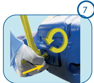
**Serrage de la clavette :** Une fois insérée, munissez-vous de l'outil de montage et insérez l'appendice carré dans le logement de la clavette. Poussez bien la clavette avec l'outil et amorcez le serrage, puis accomplissez le verrouillage par rotation de 180° dans le sens inverse des aiguilles d'une montre.
