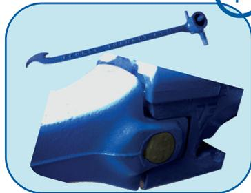
**Ejection des bouchons de protection:** Avant de procéder au démontage de la clavette ; enlever les bouchons de protection, grâce au pied de biche présent sur l'outil, et nettoyer sommairement les matériaux présents dans le carré de clavetage, afin de pouvoir bien insérer l'appendice de l'outil de démontage dans la clavette.
