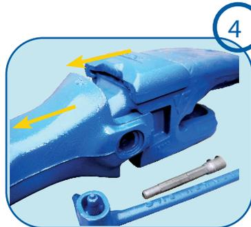
**Ejection de la dent usagée :** Une fois l'axe de clavetage extrait, procédez à l'enlèvement de la dent ainsi que du chapeau de protection.
