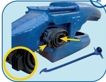
**Insertion du fourreau :** Insérez manuellement le fourreau en respectant le sens de la gorge de retenue munie de détrompeur. A partir de ce moment, munissez vous de l'outil de montage qui sera nécessaire tout au long de la procédure de montage.
