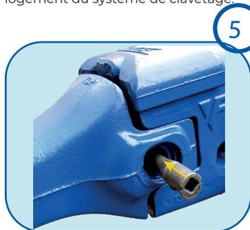
**Insertion de la clavette :** Une fois la pointe mise en butée sur l'adaptateur, munissez-vous de la clavette, et présentez cette dernière dans le passage clavette en respectant son sens d'insertion (tête en bas), et enfoncez là complètement. La clavette est munie de détrompeur afin de faciliter son insertion.
