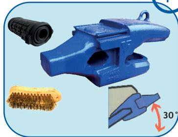
**Nettoyage :** Relevez le godet de 30° vers le haut par rapport à l'horizontale. Il est recommandé de nettoyer le nez de l'adaptateur, les queues d'arrondés du chapeau d'usure afin d'assurer le bon positionnement du chapeau et de la pointe. Nettoyer soigneusement le logement du système de clavetage.
