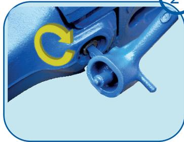
**Déclavetage :** Une fois l'outil inséré dans la clavette, déverrouillez l'axe de clavetage en tournant à 180° dans le sens des aiguilles d'une montre. Vous entendrez un CLAC sonore, vous renseignant sur le bon déverrouillage du système.
