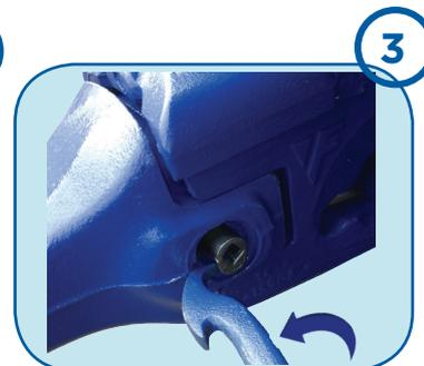
**Ejection de la clavette** : Munissez vous du mini Pied de Biche situé en bout de manche sur l'outil, insérez le dans la fenêtre et faites levier, sur la gauche, pour extraire l'axe de clavetage. Vous pouvez finir l'extraction manuellement dès que l'axe sera sorti d'1/3.
