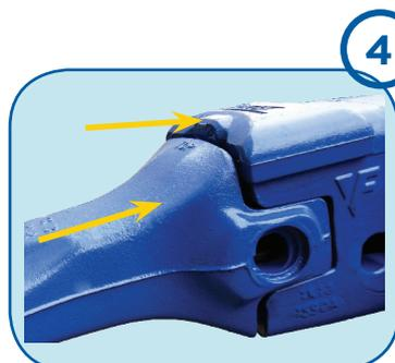
**Mise en place de la pointe** : Installez le chapeau d'usure, puis la pointe TURNKEY® sur le nez de l'adaptateur.
