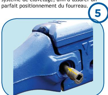
**Insertion de la clavette** : Une fois la pointe mise en butée sur l'adaptateur, munissez-vous de la clavette, et présentez cette dernière dans le passage clavette en respectant son sens d'insertion (tête en bas), et enfoncez-la complètement. La clavette est munie de détrompeur afin de faciliter son insertion.
