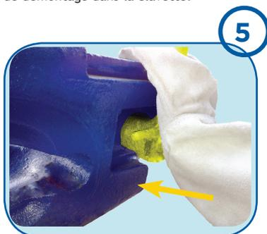
**Ejection du fourreau de clavetage** : Pour éjecter le fourreau, munissez-vous le l'outil de démontage et insérez la partie plate composée d'un appendice rond dans le fourreau par le côté gauche de l'adaptateur, et poussez avec la main afin de déloger le fourreau.
