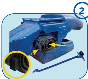
**Insertion du fourreau** : Insérez manuellement le fourreau en respectant le sens de la gorge de retenue munie de détrompeur. A partir de ce moment, munissez-vous de l'outil de montage qui sera nécessaire tout au long de la procédure de montage.
