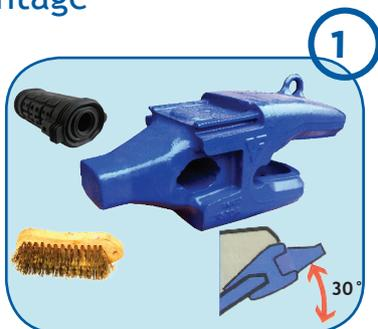
**Nettoyage** : Relevez le godet de 30° vers le haut par rapport à l'horizontale. Il est recommandé de nettoyer le nez de l'adaptateur, les queues d'arêtes du chapeau d'usure afin d'assurer le bon positionnement du chapeau et de la pointe. Nettoyer soigneusement le logement du système de clavetage, afin d'assurer un parfait positionnement du fourreau.
