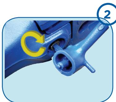
**Déclavetage** : Une fois l'outil inséré dans la clavette, déverrouillez l'axe de clavetage en tournant à 180° dans le sens des aiguilles d'une montre. Vous entendrez un **CLAC** sonore, vous renseignant sur le bon déverrouillage du système.
