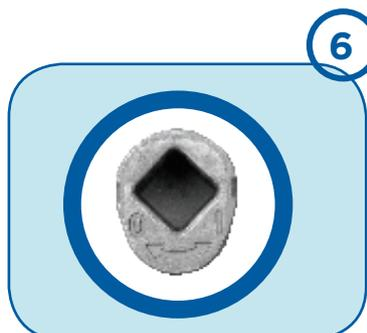
**Insertion de la clavette (suite)** : Avant le serrage, votre axe de clavetage doit être dans cette position dite : tête en bas.
