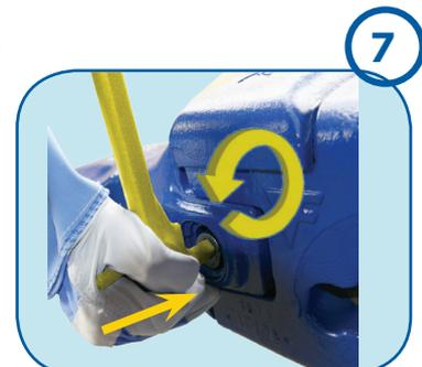
**Serrage de la clavette** : Une fois insérée, munissez-vous de l'outil de montage et insérez l'appendice carré dans le logement de la clavette. Poussez bien la clavette avec l'outil et amorcer le serrage, puis accomplissez le verrouillage par rotation de 180° dans le sens inverse des aiguilles d'une montre.
