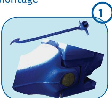
**Ejection des bouchons de protection**: Avant de procéder au démontage de la clavette ; enlever les bouchons de protection, grâce au pied de biche présent sur l'outil, et nettoyer sommairement les matériaux présents dans le carré de clavetage, afin de pouvoir bien insérer l'appendice de l'outil de démontage dans la clavette.
