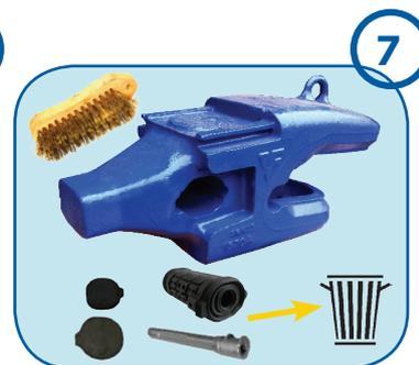
**Nettoyage** : Nettoyez l'adaptateur, les queues d'arrondes du chapeau d'usure ainsi que le passage clavette-fourreau et jetez le système de clavetage usagé. Le montage d'une nouvelle pointe doit se faire avec une clavette neuve et un fourreau neuf.
